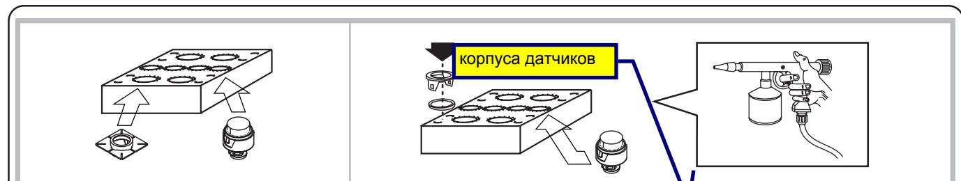
Перед тем как перейти к сборке элементов датчиков, необходимо окрасить чашеобразные излучатели и соединительные приспособления в цвета автомобиля. Для окраски используйте картонные трафареты, входящие в комплект поставки, которые служат для предотвращения попадания краски на чашеобразный излучатель, которая может привести к изменению его эксплуатационных характеристик. Перед окраской необходимо использовать первый тип краски. При сборке компонентов убедитесь, что краска полностью высохла.
